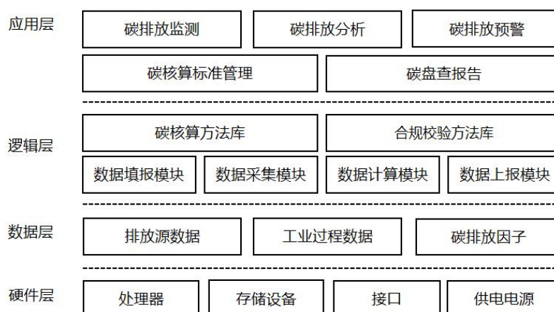
图2 碳排放在线监测终端技术架构
