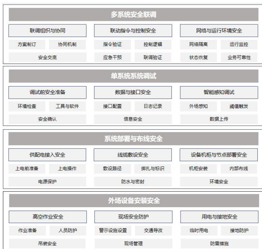
图 1 高速公路智能安全管控系统施工与调试安全规范能力框架图
