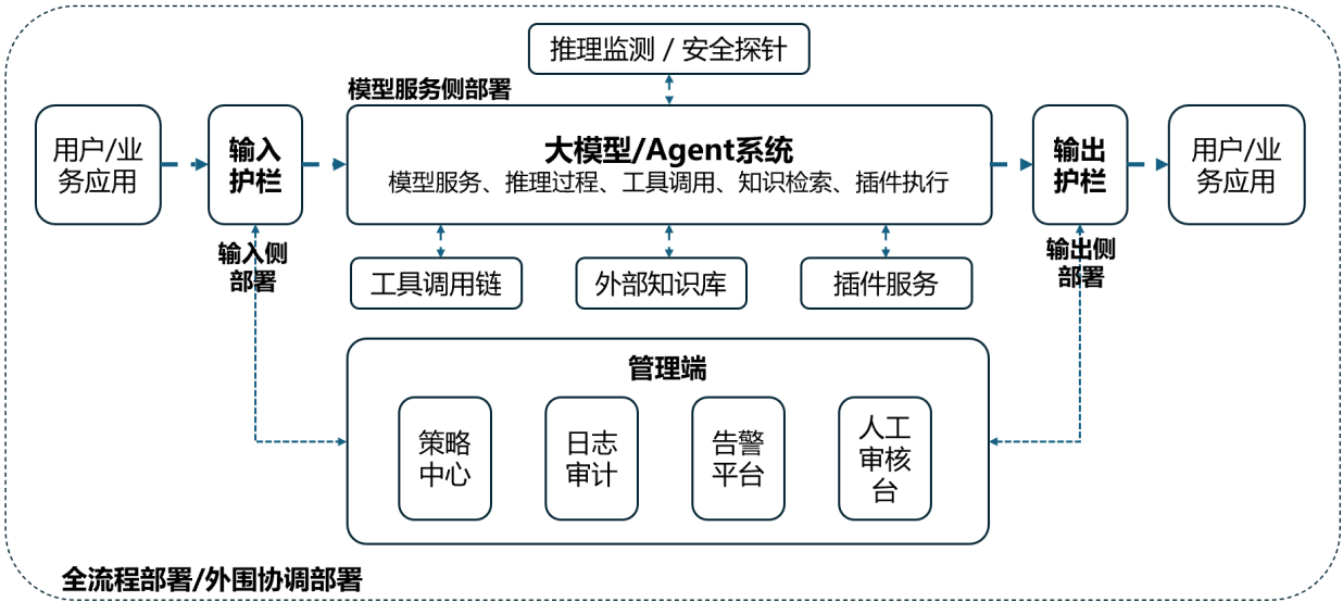
图 2 安全护栏与 AI 系统连接示意图（输入输出视角）
